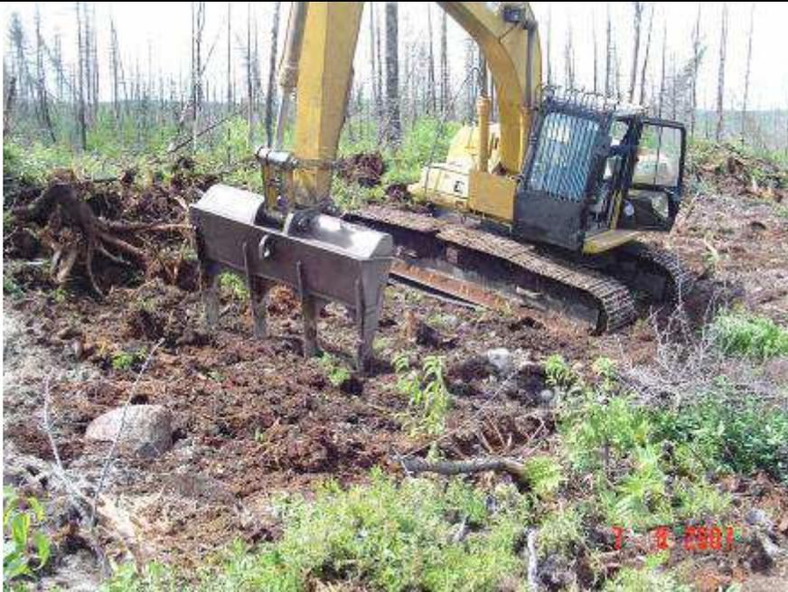
Ce traitement consiste à enlever ou à déplacer la couche de matière organique et les débris ligneux à l'aide d'une pelle excavatrice munie d'un peigne.
