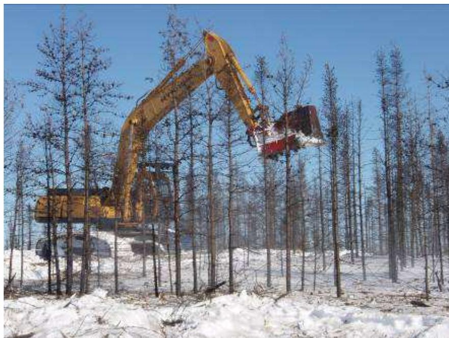
Ce traitement consiste à réduire en petits morceaux les débris ligneux et les tiges résiduelles nuisibles aux travaux subséquents (scarifiage usuel). Un scarifiage par sillon est nécessaire à la suite de ce traitement.
