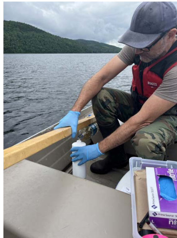
Figure 2. Transfert d'un échantillon d'eau dans un contenant pour envoi au laboratoire.
